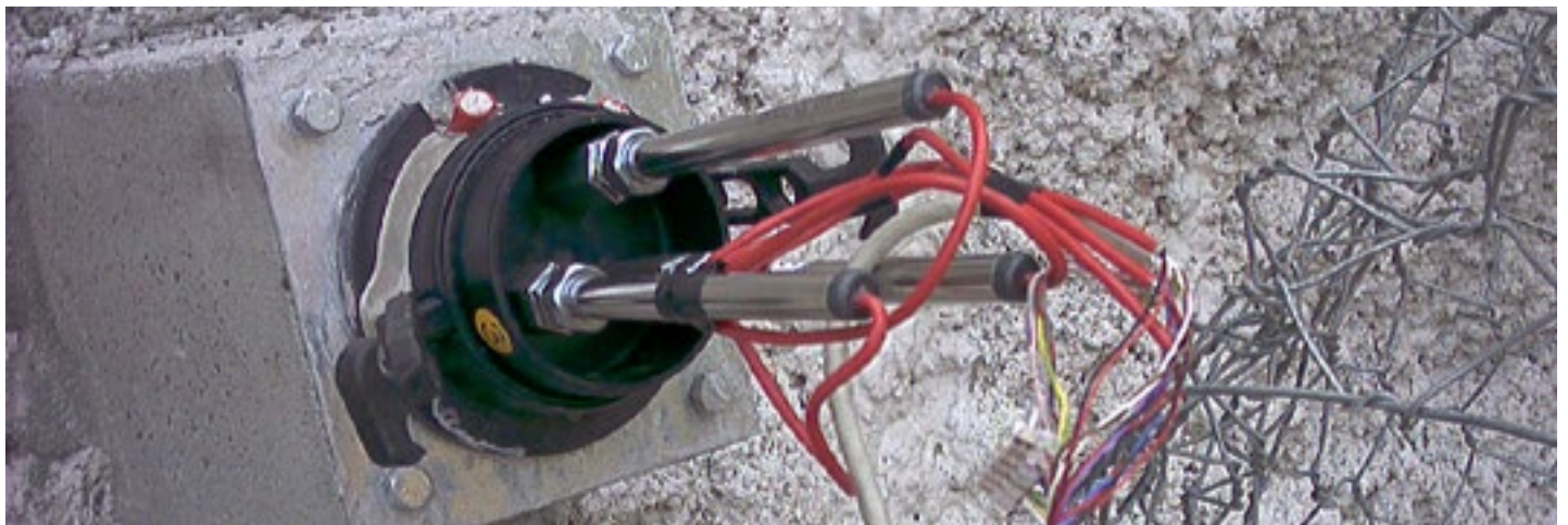
Tête MPBX avec capteurs de déplacement, installation sur un mur de soutènement
